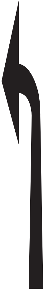
Richtungspfeil - Radweg, Linksabbieger Pfeillänge: 2000 mm, 2500 mm
